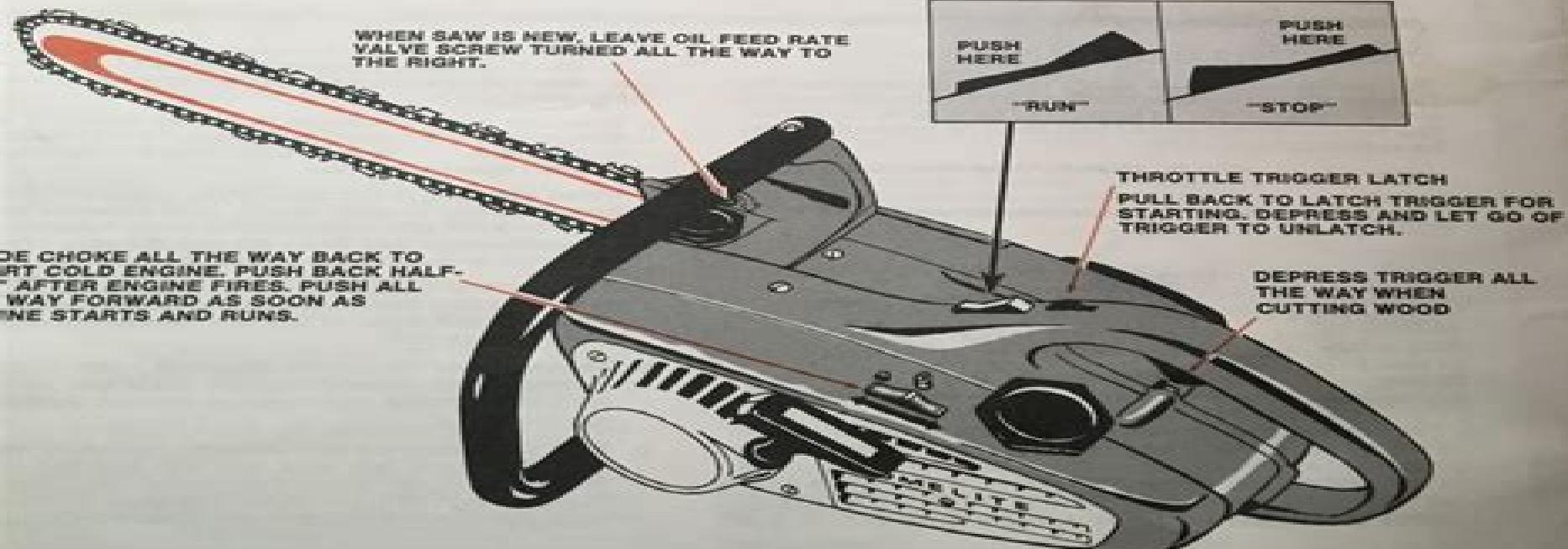
WHEN SAW IS NEW, LEAVE OIL FEED RATE VALVE SCREW TURNED ALL THE WAY TO THE RIGHT.
